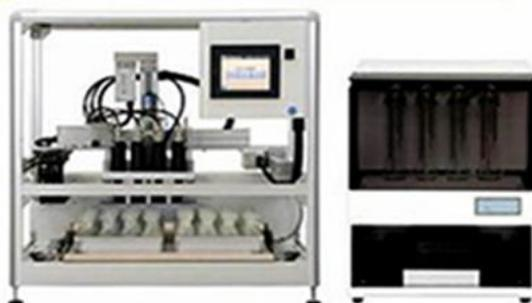
本システムは、BOD測定の希釈、測定、データ処理作業を自動化したシステムです。希釈は、サンプルを投入する事により任意の希釈倍率で倍々の8球体3段階希釈24本を、約4分で行うことができ、カセットを移す事により測定装置は、順次測定を行い、パソコンでJIS丸めまで処理が可能です。
