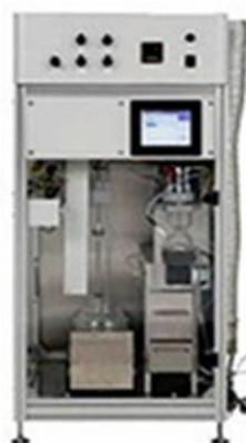
JIS K 0102 24.3抽出容器による抽出法に基づき、ヘキサン抽出を自動化した装置です。本シリーズは4、8、10検体と3機種をラインナップしており、検体数にあった機種を選択頂けます。また、環境水に対応した捕集濃縮装置も用意しております。気になるエマルジョンの濃いサンプルや、SSの多いサンプルはクロスチェックサービスをご提供します。
